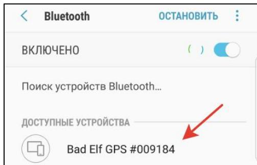
Выберите необходимое устройство и установите соединение устройств. Для этого нажмите кнопку *Да* на своем устройстве и приемнике Bad Elf.
